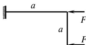
11. Определить вертикальное перемещение сечения А в балке. Жесткость балки на изгиб –  $EI$ .
